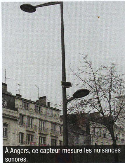
À Angers, ce capteur mesure les nuisances sonores.
